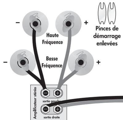
sur les bornes de raccordement des enceintes, consultez la section « Raccord à deux fils » pour obtenir les instructions relatives au raccordement.
