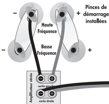
**Fig. 2:** Raccord à deux fils. Un canal illustré.
